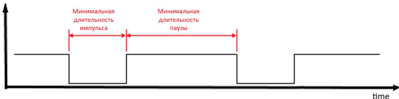
3. Помимо фильтрации импульсов по длительности паузы и импульса в счетчике импульсов предусмотрена возможность фильтрации импульса по фронту и спаду. Для детальной настройки следует обратиться к группе параметров фиксации импульсов на входах. Доступны значения: "по замыканию" (по спаду), "по размыканию" (по фронту) или "по замыканию и размыканию".
