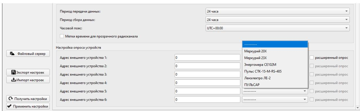
**ModBus RTU.** Обмен данными с подключенным к СИ-23 устройством происходит с использованием протокола ModBus RTU. При необходимости этот режим можно настроить, воспользовавшись клавишей «Добавить настройку». В раскрывшемся меню можно провести настройку следующих параметров:
