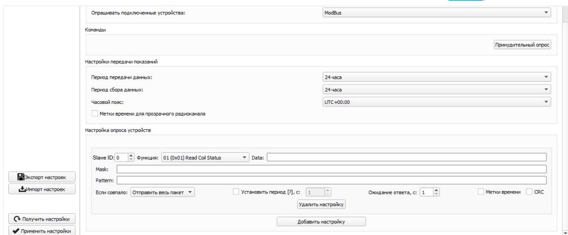
*Slave ID* – адрес подключенного устройства.
