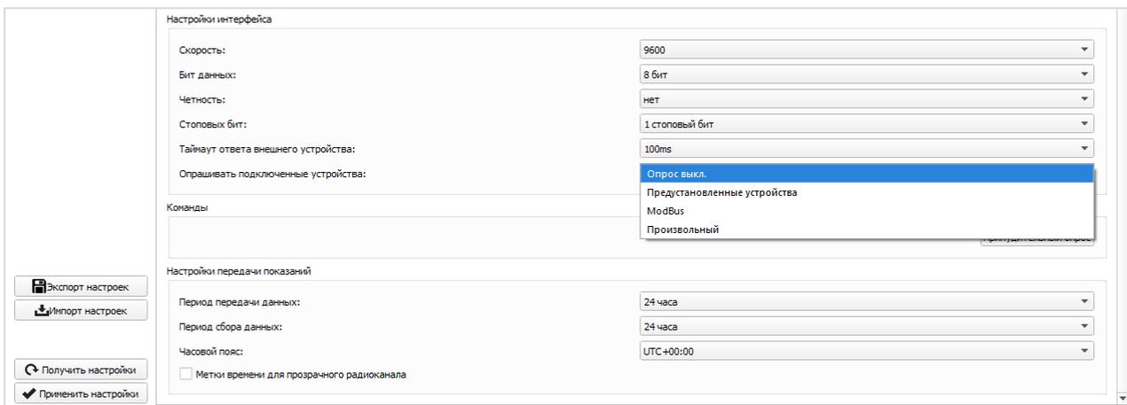
В режиме самостоятельного опроса может быть 4 варианта работы. Во всех режимах активен «прозрачный радиоканал» и периодическая отправка информации о накопленных импульсах, тревогах и прочих параметрах устройства Вега СИ-23.
