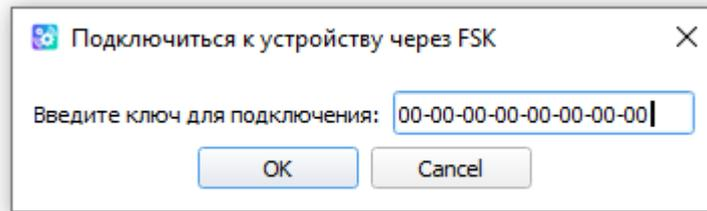
7. Поднести магнит на 1-2 секунды к датчику Холла устройства или дождаться автоматического подключения (устройство активирует радиоканал FSK раз в две минуты).
